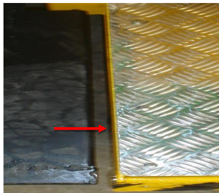
Figura 17 - Pontos de vedação da plataforma com a base da carroceria.
