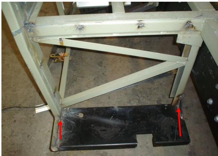
Figura 8 - Indicação dos pontos de fixação da base.
