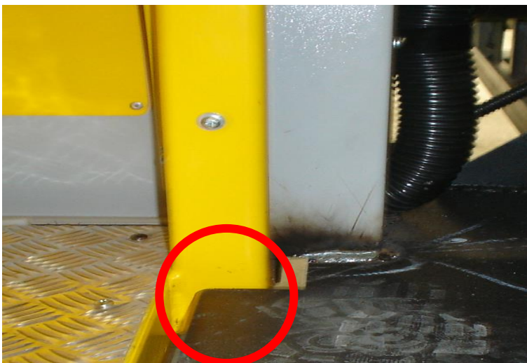
Figura 13 - Indicação do ponto onde deverá ser efetuada a solda.
