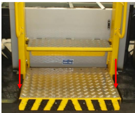
Figura 16 - Pontos de vedação da plataforma com a base da carroceria.
