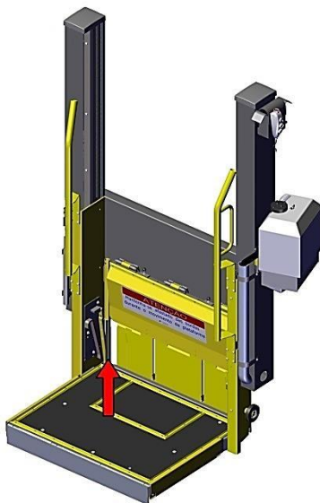
Figura 36 - Indicação das molas e tubos guia.
